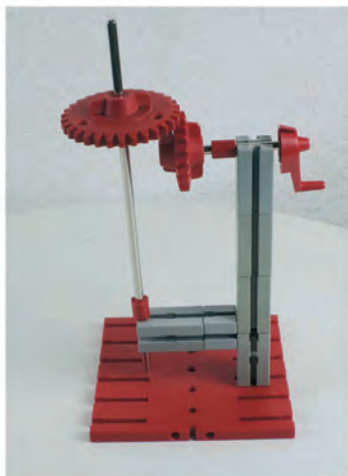
Abb. 7: Optimierung: einfache Zahnräder und Kegelnzahnäder.
