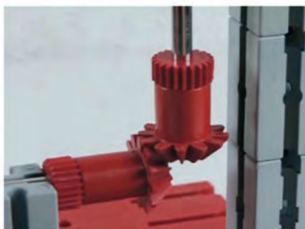
Abb. 7: Optimierung: einfache Zahnräder und Kegelnzahnäder.
