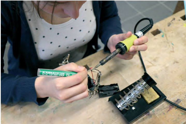
Abb. 3: Zugangsmöglichkeit: Weichlöten im Herstellungsprozess einer Taschenlampe (Foto: Andreas Mikutta).
