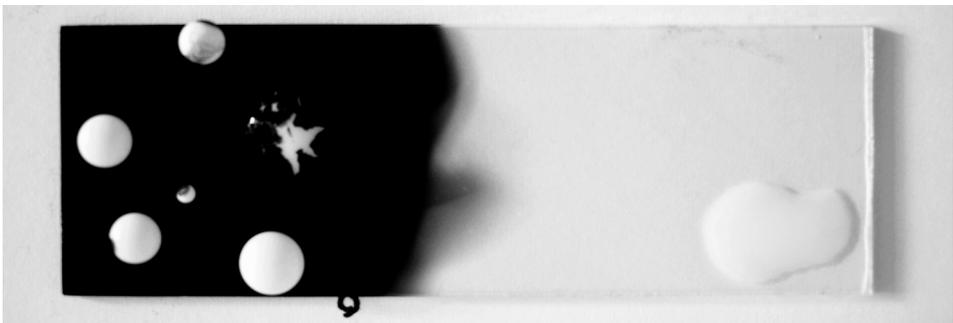
Abb. 3: Lotos-Effekt: Ruß-Nanopartikel aus einer Kerzenflamme bilden eine wasserabweisende Schicht auf einem Glas-Objektträger. Rechts zum Vergleich ein zerlaufener Tropfen auf dem unbehandelten Glas.
