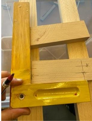
Die kurzen Holzleisten werden im rechten Winkel auf den langen Holzleisten mittels Schrauben fixiert. Durchführung der Bohrungen mit einem 3,5 mm Bohrer. Vor den Bohrungen die Löcher mit einem Senker ansenken (siehe **Abbildung 1, Nr 1**).
