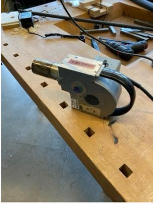
Die Biegung des Rohrs erfolgt mittels Heißluftfön. Dafür wird das Rohr, wieder von der Pumpe getrennt, mit Sand befüllt und beide Seiten mit Klebeband verschlossen.
