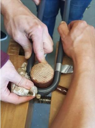
Das PVC-Rohr (16 mm) wird erwärmt und mittels eines Rundholzes oder Holzhammer gebogen. Das Rohr wird anschließend mit kaltem Wasser abgekühlt.
