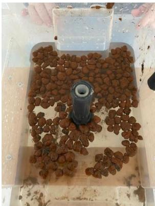
Dafür wird etwas Klebeband um das innere Rohr gewickelt und in das Rohr mit größerem Durchmesser gesteckt (es muss komplett abschließen). Sollte dies ebenfalls nicht ausreichen, wird das transparente Rohr mit derselben Technik hineingesteckt. Dieser Durchmesser ist dann ausreichend klein genug.
