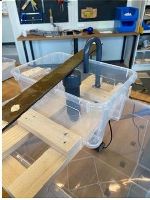
Für die Anfertigung des Siphon-Systems wird das PVC-U Druckrohr 20x1,5 mm zugeschnitten. Die Höhe kann variiert werden, je nachdem wie hoch der Wasserstand gewünscht ist (siehe **Abbildung 1, Nr 4**).
