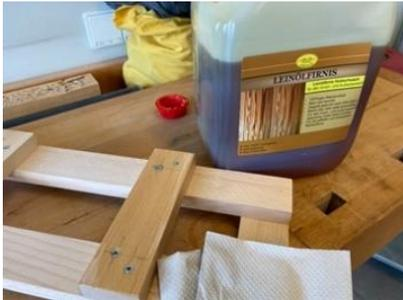
Einlassen der Holzauflage mit Leinöl, um das Holz zu versiegeln, wodurch der Nachhaltigkeitsaspekt beachtet wird. Anschließend kann die kleine Box auf der Holzkonstruktion aufgebracht werden.
