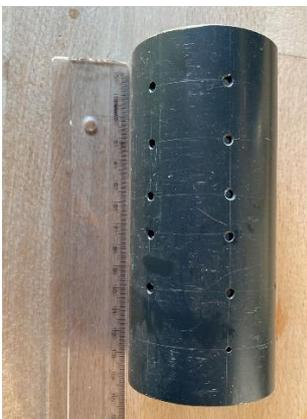
Zum Schutz des Siphons und damit dessen Funktion gewährleistet werden kann, wird das PVC-U Druckrohr 63x1,5 mm zugesägt (etwa 14,5 cm) und etwa in einem 2 cm Abstand quer und 3 cm längs 3 mm große Bohrungen angefertigt.
