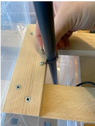
Das gebogene Rohr wird erneut auf die Pumpe aufgesteckt und an der Holzkonstruktion mit einer Feder fixiert. Dafür werden zwei Nägel in eines der kurzen Hölzer geschlagen und eine Feder angebracht.
