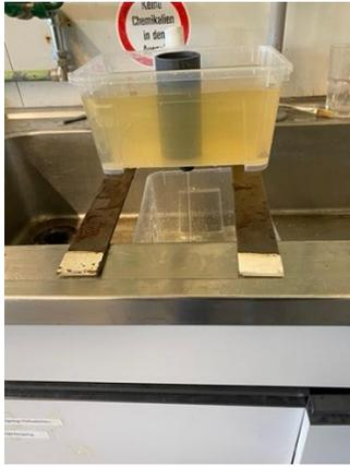
Der Schutz kann aufgesetzt werden. Anschließend sollte zur Testung der Anlage Wasser eingefüllt werden. Sollte der Siphon nicht richtig funktionieren, das Wasser nicht oder nur langsam abfließen, ohne dass sich das Ebbe-Flut-Verhalten einstellt, muss nachgearbeitet werden.
