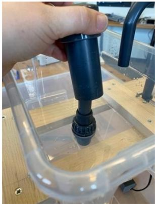
Damit das Wasser besser einströmen kann, werden am unteren Rand insgesamt 4 etwa 3 mm hohe Kerben eingefräst. Anschließend wird das Rohr locker aufgesetzt (siehe **Abbildung 1, Nr 4**).
