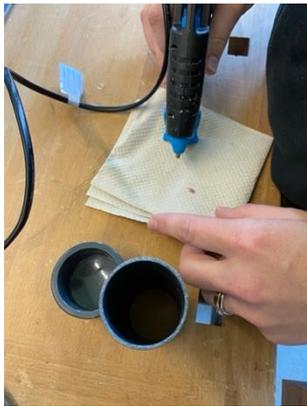
Das PVC-U Druckrohr 40x1,5 mm wird abgemessen, dies muss ein paar mm länger sein (9,5 cm) als das zuvor geschnittenen PVC-U Druckrohr mit 20x1,5 mm (9 cm). Mit Heißkleber wird die Kappe des Siphons mit dem Rohr fest verbunden. So wird verhindert, dass Wasser oder Luft von außen hindurch kommt und sichergestellt, dass der Siphon funktionieren kann (siehe **Abbildung 1, Nr 4**).
