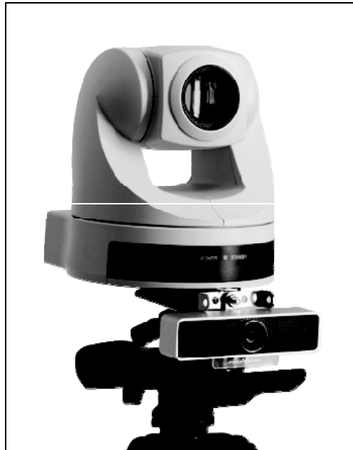
Abbildung 1: LectureSight-Kameraaufbau, oben Produktionskamera, unten Übersichtskamera (eigene Darstellung)
