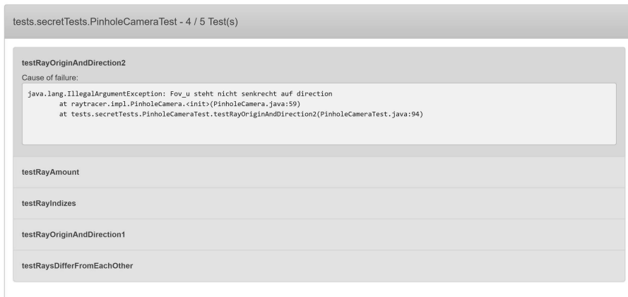
Abbildung 15.3: Studierende können bestandene und nicht bestandene Tests einsehen. Zu letzteren wird das Feedback der TestSuite (hier JUnit) angezeigt.
